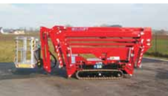
Das hydraulisch verstellbare Raupenfahrwerk ermöglicht das Arbeiten in schwierigem Gelände. Die Verstellung lässt sich bequem von der Funkfernsteuerung und vom Korb aus bedienen.
