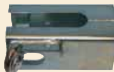
Diebstahlsicherung für Kugelpopfkupplung
