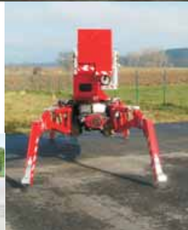
Die kleinste Abstützvariante ist mit 2 m extrem schmal und erweitert den Einsatzbereich erheblich.
