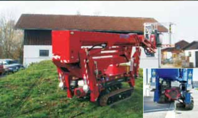
Das hydraulisch verstellbare Raupenfahrwerk ermöglicht das Arbeiten in schwierigem Gelände. Die Verstellung lässt sich bequem von der Funkfernsteuerung und vom Korb aus bedienen.
