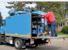
Für den **Verkehrsbetrieb Ostrava** wurde ein Spezialgerät mit GSR E142TJV aufgebaut. Ausstattung: Doppelte Isolation für Arbeiten an der S-Bahn-Oberleitung, isolierter HEGENSCHIEDT-Schrank und BÄR-Laderampe.
