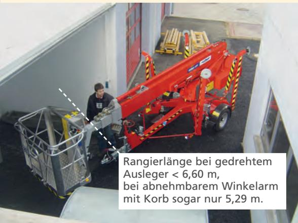
Rangierlänge bei gedrehtem Ausleger < 6,60 m, bei abnehmbarem Winkelarm mit Korb sogar nur 5,29 m.
