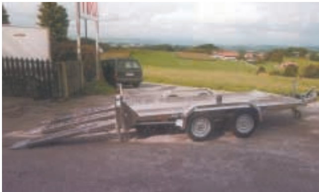
PKW-Anhänger GTAL 350-3,5 mit 2400 kg Nutzlast, Sonderausführung mit langer Zugdeichsel für Transport DENKA•LIFT Narrow. In Tieflader-Bauweise mit niedriger Ladehöhe.
