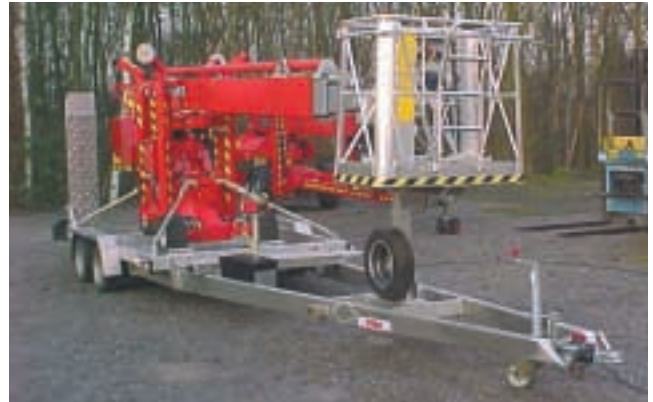
PKW-Anhänger GTAL 350-3,5 mit 2960 kg Nutzlast, Ladelänge von 3,50 m und Ladebreite von 1,85 m.
