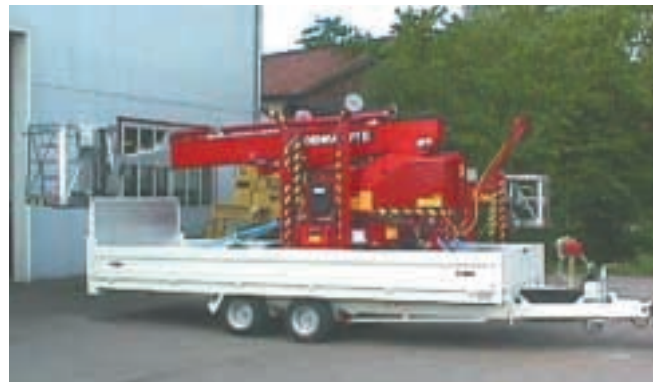
PKW-Anhänger ATPHK 500-3,0 mit 2300 kg Nutzlast, Ladelänge 5,0 m, Ladebreite 1,90 m. Mit hydraulischer Kippvorrichtung und in der Plattform eingearbeiteten Radmulden für DENKA•LIFT Narrow.
