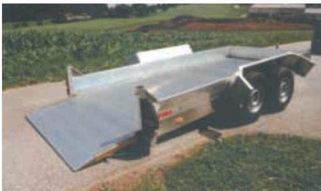
PKW-Anhänger GTAS 450-3,5 mit 2730 kg Nutzlast, Ladelänge von 4,50 m und Ladebreite von 1,80 m. In Tieflader-Bauweise mit hydraulisch absenkbarer Tandemachse. Mit ca. 5° sehr flacher Auffahrwinkel.
