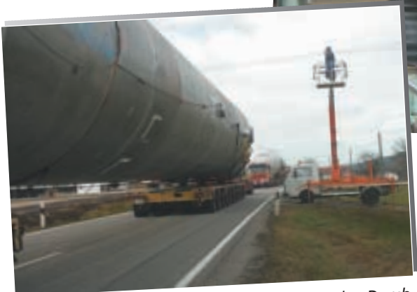
DENKA•LIFT Lkw 1900 bei der Sicherung der Durchfahrtshöhen für einen Schwertransport
