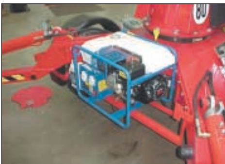
Benzinaggregat 3,0 kW mit Drehzahlregelung und Handstart auf DK18
