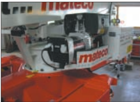
Dieselaggregat 3,7 kW mit Handstart auf DK25
