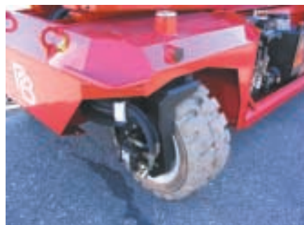
90° Lenk-Einschlagwinkel, weiße Reifen
