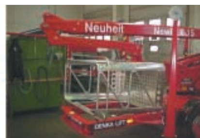
15m Denka-Anhänger mit beweglichem Korbarm und neuer Steuerung
