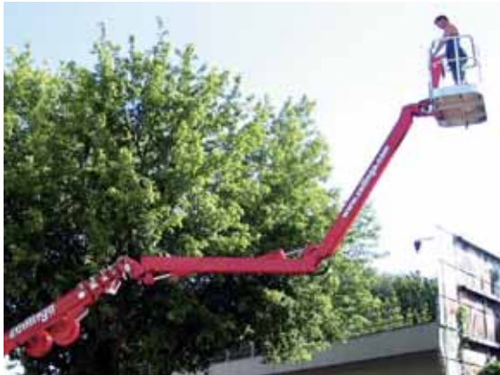
2x3m Doppelgelenk-Korbarm ermöglicht einen Arbeitsbereich von 2x180°
