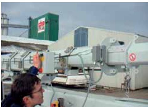
Trennen des Doppelkorbarms vom Teleskop-Hauptausleger
