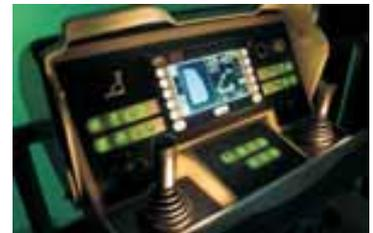
Gehört auch beim Kleinsten zum Standard: das Bedienpult im Arbeitskorb mit hochauflösendem TFT Farbdisplay
