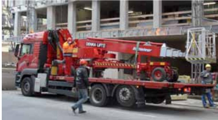
Als Innen-Spezialgerät zeichnet sich der DL28N vor allem durch die Abmaße mit einer Breite von 0,88m und Durchfahrt unter 2m aus. Damit stellen sogar Zimmertüren für den Narrow kein Hindernis dar. Von der detaillierten Bedarfsanalyse, bis hin zur Projektierung und Organisation der Auslieferung mit Bedienerweisung wurde der Kunde von unserem österreichischen Vertriebsfachmann Bernhard Spörk betreut.
